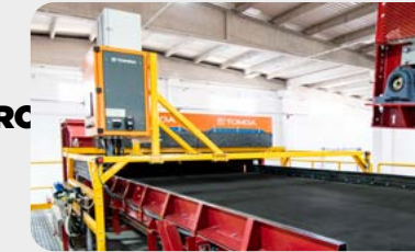
7 OPTICAL SORTER 2 (HDPE / HDPE&PET&PP)
