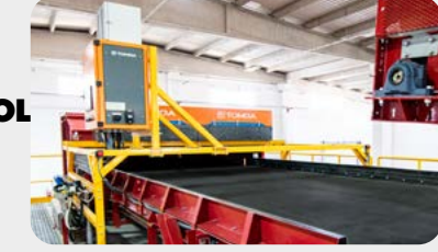
7 OPTİK SEPARATOR 2 (HDPE / HDPE&PET&PP)
