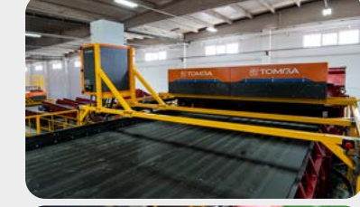
8 OPTİK SEPARATOR 3 (PET [RENKLİ; ŞEFFAF & AÇIK MAVİ; PET HARİCİ] / HDPE [RENKLİ; ŞEFFAF&BEYAZ; HDPE HARİCİ])
